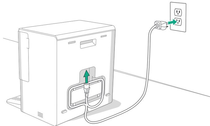
Collega il cavo di alimentazione alla presa a muro. Riavvolgi il cavo per evitare di intralciare il movimento del robot.
