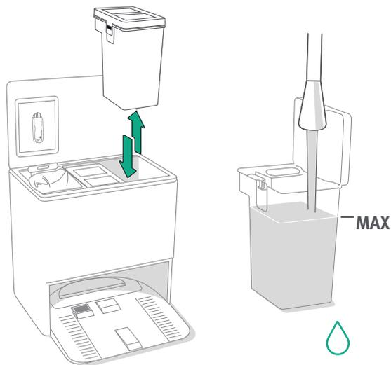
Rimuovi il serbatoio dell'acqua pulita (a destra) dalla stazione AutoWash™. Riempi il serbatoio dell'acqua pulita.
